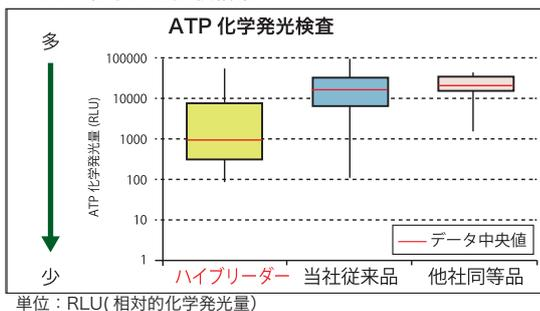
食品業界や医療機関で器具の洗浄度調査に実施されている ATP 化学発光試験は、微生物や食物の残渣などの付着した汚れを酵素で発光させ、その発光量によって汚れ度合いを評価する試験です。「ハイプリーダー」の試験中央値 (1000RLU) は当社従来品及び他社同等品 (10000RLU) に比べ 10 分の 1 以下と低い値となっています。汚れがつき難い優れた防汚性、洗浄性を検証。
