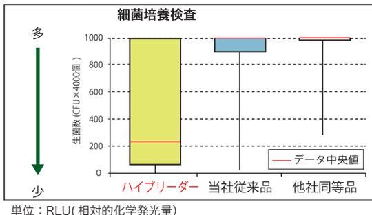
振とう洗浄した洗浄水を 10 倍に希釈し、24 時間培養後の細菌数を測定。「ハイプリーダー」の中央値 (200 強 CFU) の値は、当社従来品及び他社同等品の値 (最大値 1000CFU 以上=∞個) に比べ、遥かに低い値です。細菌が付着し難い衛生的な仕様を実現。
